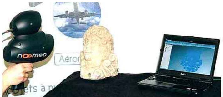
Scanner portable, capable de reconstituer n'importe quel objet réel en 3D pouvant mesurer jusqu'à... 3 mètres cubes.
